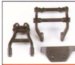
Spoiler Bracket 尾翼支架
